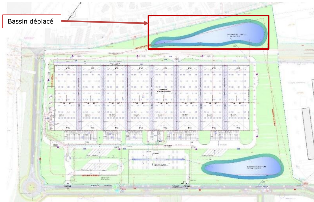
Figure 1 : Plan de masse du projet initial et localisation du bassin de tamponnement déplacé.
